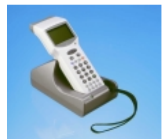
IRU 2700 Datenübertragung und Laden der Akkus
