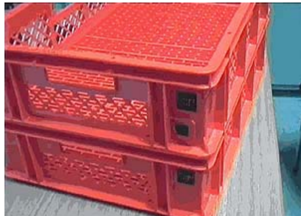
Logistik Gebinde mit eingegossenen RFID-Inlays von TAGSYS
